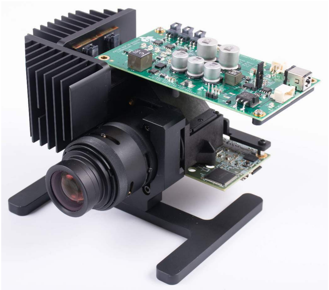
Figure 8. DLP5530PROJTGQ1EVM Optical Module
