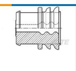
TE Part #963244-1 EINZELDRAHTDICHTUNG
