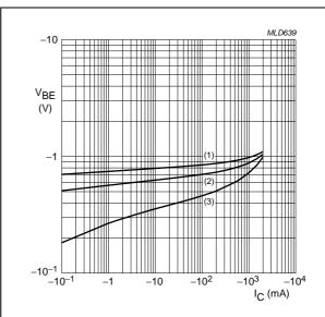
**TR2 (PNP);**  $V_{CE} = -5 \text{ V}.$
