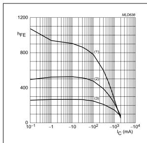
**TR2 (PNP);**  $V_{CE} = -5 \text{ V}.$
