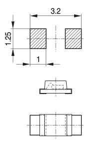
Bauteil positioniert Component location on pad OHFP2578
