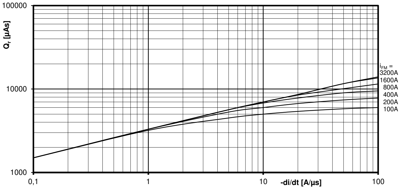
Sperrverzögerungsladung / Recovered charge Q_r = f(-di/dt)
