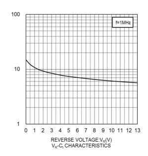
CAPACITANCE BETWEEN TERMINALS:C<sub>t</sub>(pF)
