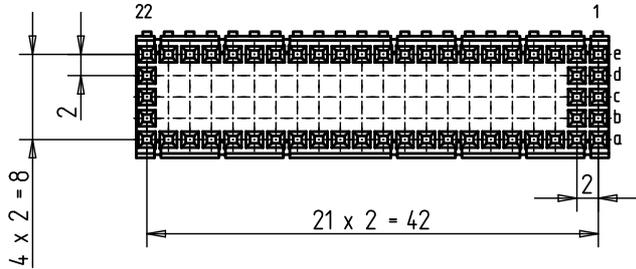
EE-Zone für durchkontaktierte Löcher  $\Phi 0.6 \pm 0.05$
