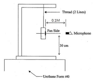
0.1 METER FROM MICROPHONE TO FAN INTAKE
