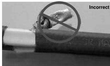
17.1 Positionnez le raccord de sertissage de tresse comme illustré (Figure 17-1, Figure 17-2, Figure 17-3).
