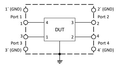
Network Analyzer: Keysight E5080A or equivalent
