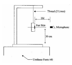
1 METER FROM MICROPHONE TO FAN INTAKE
