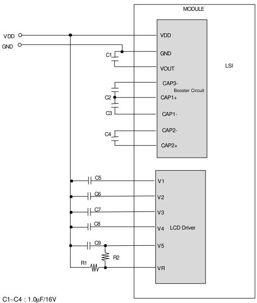
C1~C4 : 1.0 $\mu$ 1716V C5~C8 : 0.68 $\mu$ F/16V R1 : 270K $\Omega$ ±0.2% R2 : 1.1M $\Omega$ ±0.2%
