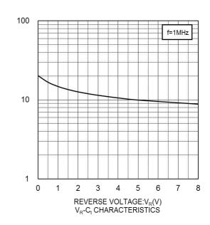
CAPACITANCE BETWEEN TERMINALS:C<sub>t</sub>(pF)
