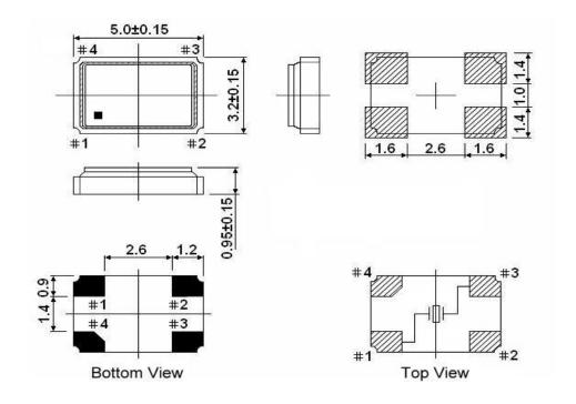
\*\* Recommended - Pin 1 & 3 : CRYSTAL Pin 2 & 4 : GND
