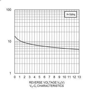
CAPACITANCE BETWEEN TERMINALS:C<sub>t</sub>(pF)
