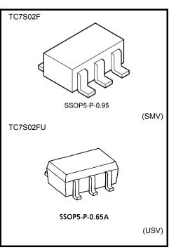
Weight SSOP5-P-0.95 : 0.016 g (typ.) SSOP5-P-0.65A
