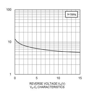
CAPACITANCE BETWEEN TERMINALS:C<sub>t</sub>(pF)
