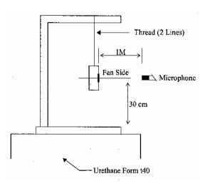
1 METER FROM MICROPHONE TO FAN INTAKE
